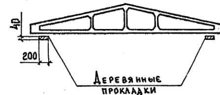
СХЕМА ОПИРАНИЯ ФЕРМ ПРИ ХРАНЕНИИ И ПЕРЕВОЗКЕ
