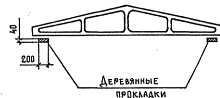
СХЕМА ОПИРАНИЯ ФЕРМ ПРИ ХРАНЕНИИ И ПЕРЕВОЗКЕ
