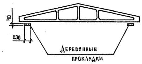
Схема опирания ферм при хранении и перевозке
