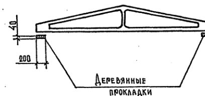
Рис. 3 Схема опирания фермы при хранении и перевозке
