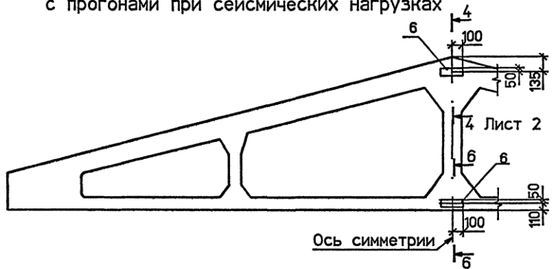
Рис. 8. Для крепления связей к средним фермам в покрытии с прогонами при сейсмических нагрузках
