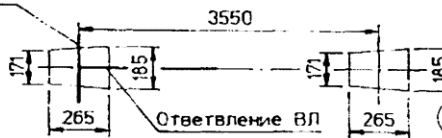
Схема установки стоек опоры
