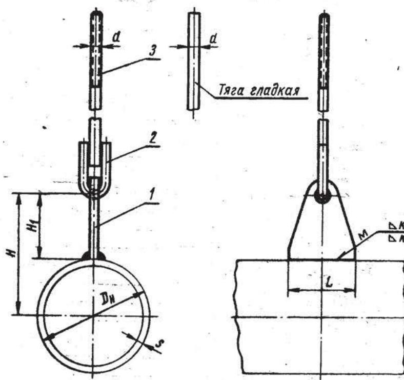
Пример обозначения блока подвески для трубопровода  $D_n=68$  мм с тягой  $d=M10$ :
